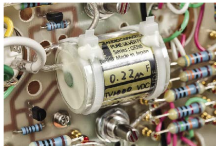
Okazałe kondensatory ze srebrną folią to ekskluzywne elementy Kondo.
