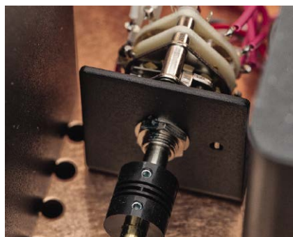
Do przełączania sygnałów wejściowych służy mechaniczny wybierak umieszczony tuż przy gniazdach RCA.
