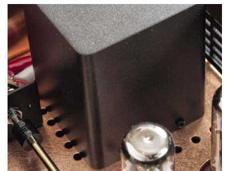
Każdy z transformatorów głośnikowych ma własną obudowę (zalaną wytlumieniem i pełniącą rolę ekranu).
