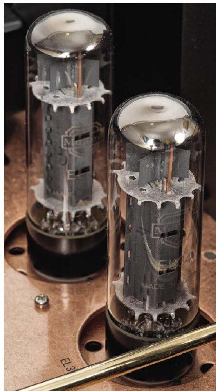
W stopniu mocy pracują pentody EL34 firmowane przez Mullarda.
