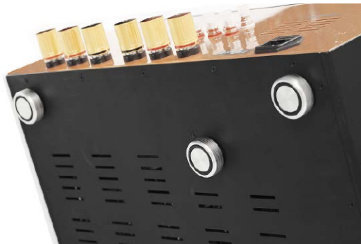
Piąta stopka podpira konstrukcję pod transformatorami.
