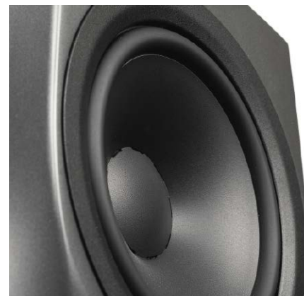
52-mm cewka dla 18-cm przetwornika (sama membrana ma 12,5 cm) to część solidnego napędu z magnesem neodymowym. Membrany wykonano z MSP – z tym materiałem Dynaudio nie chce się rozstać.
