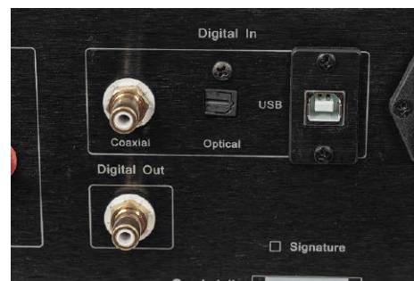
Gniazdo USB przyjmie sygnały PCM 24/384 i DSD128.
