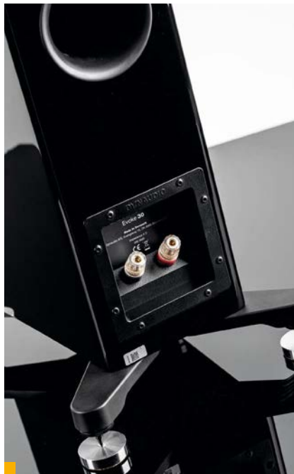
Terminale głośnikowe (dobrej jakości) skryto w zagłębieniu tylnej ścianki. Jak zwykle u Dynaudio, są pojedyncze.
